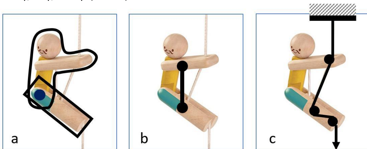
Obr. 2a, b, c: Konštrukcia hračky. a – dve pevné, cez kĺb navzájom pohyblivé časti panáčika, b – gumička upevnená medzi rukou a nohou, c – lanko prevlečené cez otvory panáčika (zhora visí, dolu padá a možno ho potáhať)
